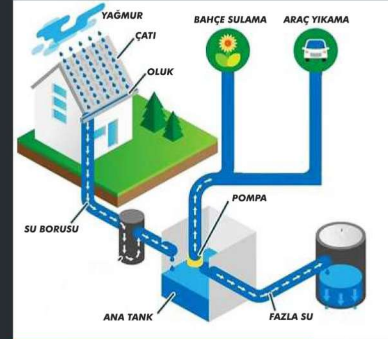
GRİ SU TOPLAMA HAVUZU
